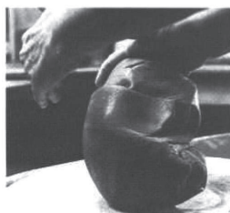
Frământare lut. Pregătire olărit. (Susan Peterson, Fare Ceramica , Ed. Zanichelli, p. 32)
