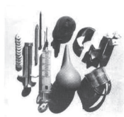
Unelte necesare pentru rihtuirea, modelarea și turnarea formelor (Dolors Ros, Keramiken herstellen und verzieren , Ed. Michael Fischer, p.10)
