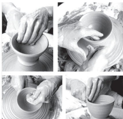
Roata electrică. Ridicarea unui vas ceramic. (Susan Peterson, Fare Ceramica , Ed. Zanichelli, p.119)
