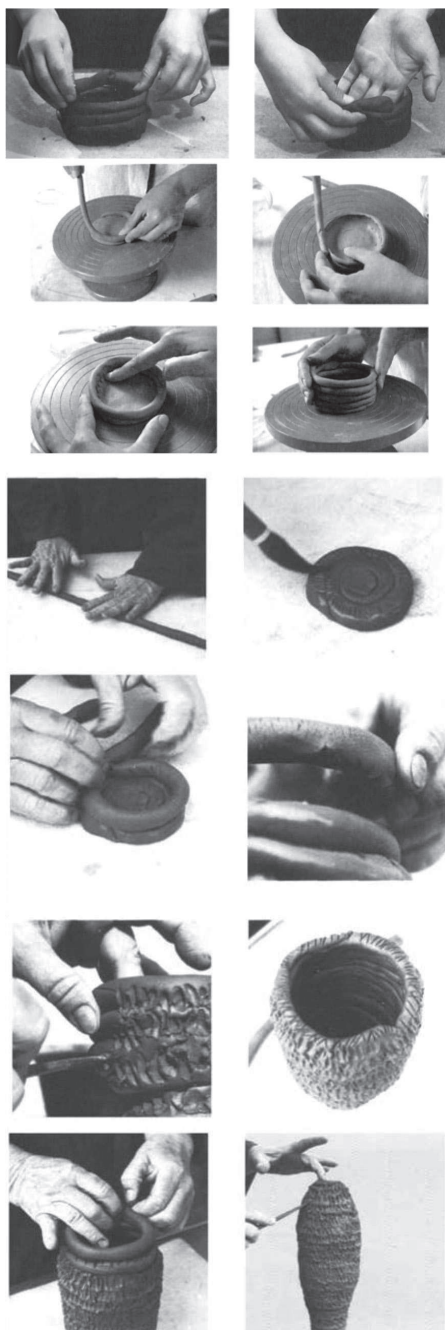
Tehnica „colombino”. Confecționarea unui vas din suluri bătute în spirală. (Susan Peterson, op. cit. , p. 94)
